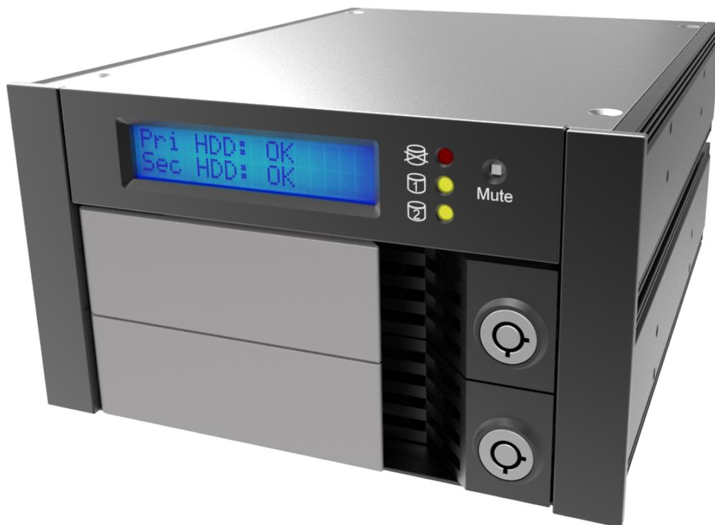
新增 RS232 連接埠的 SR2611-2S-S2R+ 磁碟陣列系統，可承載 2 顆 3.5 吋 SATA 硬碟，內建 RAID 0 和 RAID 1 功能，RAID 0 可加總兩顆硬碟容量且讀寫速度快，RAID 1 可將儲存的資料以鏡射的方式同時做備份。並可透過 RS232 連接埠提供工控產業或 IPC 產業進行硬體狀態偵測。配備蜂鳴器，隨時監控硬碟運作狀況，硬碟損壞時，系統會自動發出聲響，提醒使用者更換新硬碟。SR2611-2S-S2R+ 是符合小型企業或工業電腦等作業環境需求的最佳資料備份幫手。
